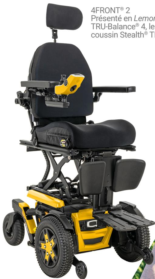
Le 4Front 2 révolutionne la traction. Le nouveau contrôleur de traction intelligent (STC), ainsi que les suspensions Smooth Ride (SRS), offrent stabilité et souplesse pour des passages d'obstacles en douceur et des performances de conduite inégalées. Les nouvelles fonctionnalités incluent des moteurs à 4 pôles et des fourches redessinées pour une meilleure durabilité, une esthétique améliorée et un poids réduit.
