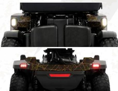
Le système d'éclairage LED, activé par interrupteur, améliore la visibilité et la sécurité avec des LED installées sur le capot avant et à l'arrière des garde-boues, au-dessus des pneus.
